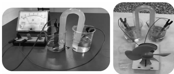
图9 双液原电池带动风扇转动
